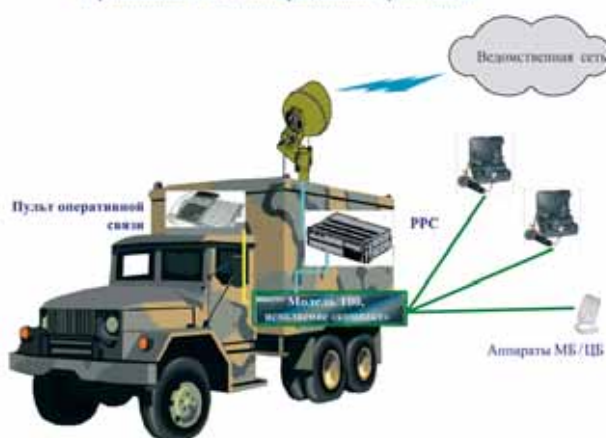
Применение в составе передвижного узла связи
